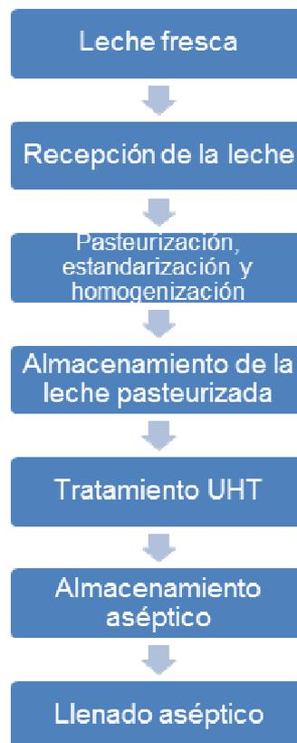
obtener la cantidad total de sólidos y de grasa deseada. Esta mezcla se pasteuriza después para matar las bacterias patógenas antes de homogeneizarlo y para garantizar una solución más estable.
